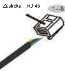
Obrázek 4.36 Obnažení izolace a připojení k zástrčce RJ45
